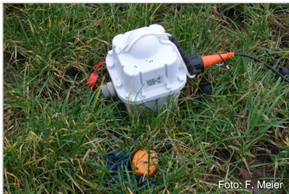
Geophon mit kabelloser Registriereinheit
