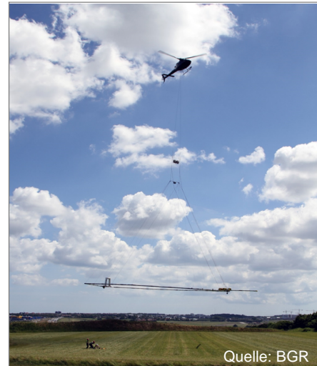
Aero-Elektromagnetik: Helikopter mit Sende- und Empfangseinheit
